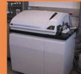
El ICP-MS permite realizar el análisis químico de los huesos fósiles. ICP-MS-rekin hezur fósilen azterketa kimikoa burutu daiteke.
