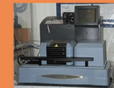
La Balanza Termo Gravimétrica mide la pérdida de masa a medida que se incrementa la temperatura.
